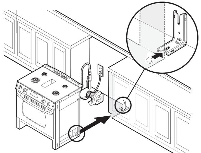
7. Vérifier que le raccord flexible et le cordon électrique ne sont pas pincés. Au moyen d'une torche électrique, inspecter le dessous de la cuisinière.
