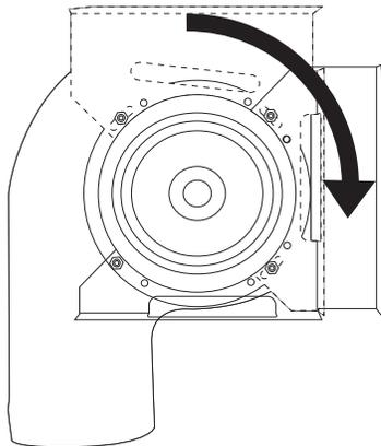
9. Placer le ventilateur dans l'ouverture entre les placards et le fixer au sol.
