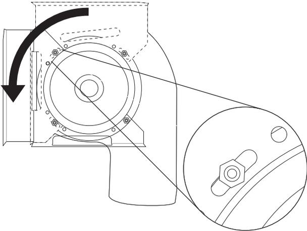
8. Dévisser le support de l'autre côté du ventilateur, le faire pivoter de 90° et le fixer avec les 4 écrous de blocage.
