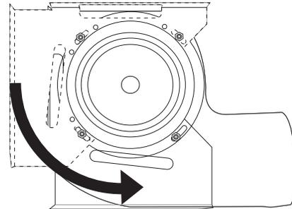
8. Fixer le ventilateur au sol avec les 4 vis n°8 x ¾" à tête hexagonale fournies.
