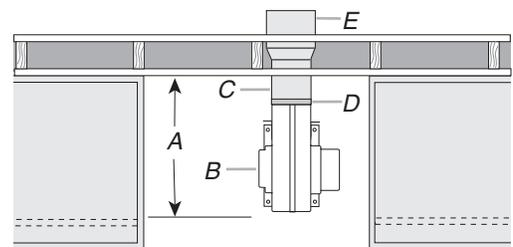
A.  $18\frac{3}{4}$ " (47,6 cm) maximum entre l'ouverture entre les placards et le mur arrière
