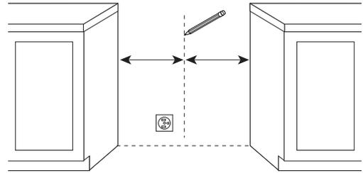
2. Vérifier l'absence d'obstruction avant de repérer l'emplacement du trou d'évacuation. Tracer une ligne horizontale à  $8\frac{3}{16}$ " (20,8 cm) du sol. Tracer une ligne verticale à droite de l'axe central entre les placards, à une distance de  $2\frac{1}{4}$ " (7,9 cm) au maximum de l'axe central.
