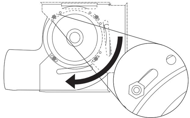
7. Dévisser le support de l'autre côté du ventilateur, le faire pivoter de 90° et le fixer avec les 4 écrous de blocage.
