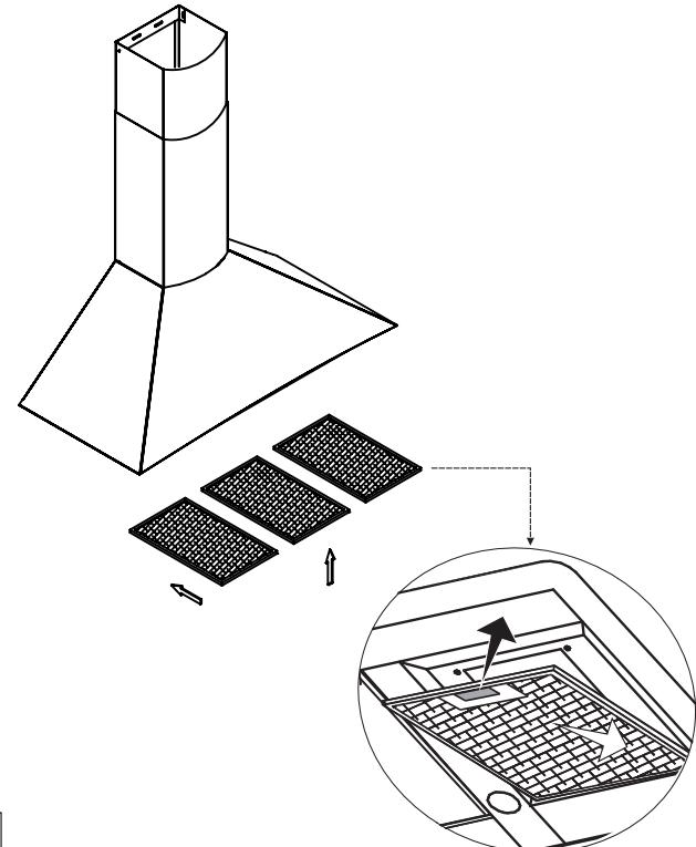
Remplacez également tout filtre endommagé qui présente des perforations, des mailles endommagées, un cadre brisé ou tordu.
