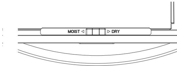
Le curseur de réglage Moist-Dry (humide-sec) permet d'ouvrir ou de fermer les ouvertures d'aération dans la porte. Le réglage MOIST (humide) retient l'humidité tandis que le réglage DRY (sec) permet à la vapeur et à l'humidité de s'échapper du tiroir.
