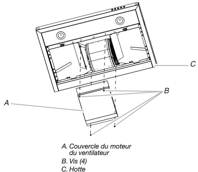
5. Déconnecter le moteur du ventilateur du câblage de la hotte. Appuyer sur les languettes supérieure et inférieure du connecteur électrique à 9 broches pour le débrancher.
