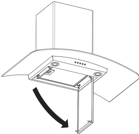
4. Retirer le filtre à graisse métallique en tirant sur la poignée à ressort puis en tirant le filtre vers le bas.
