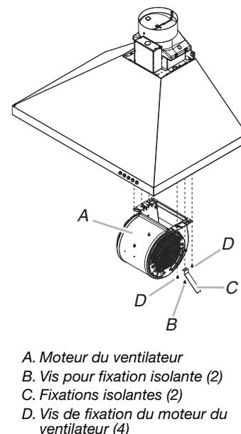
7. Pousser le moteur du ventilateur pour dégager les deux languettes à ressort des orifices en trou de serrure situés en haut de la caisse de la hotte.
