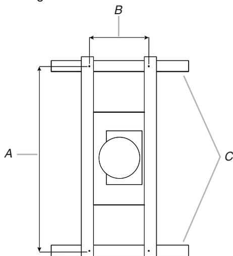
A. Distance entre orifices d'installation : 24" (61 cm), 19½" (49,2 cm), 18" (46,2 cm) et 14½" (36,8 cm)
