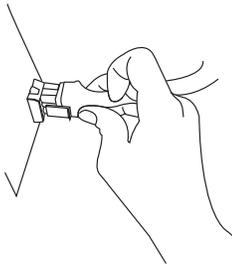
6. À l'aide de l'adaptateur Torx® T20® équipé d'une rallonge, ôter les 4 vis qui maintiennent le moteur du ventilateur à la caisse de la hotte et les mettre de côté.
