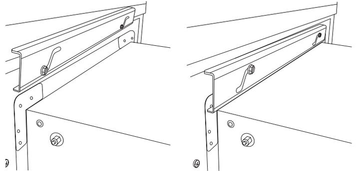
9. Réinstaller le panneau sur le côté avant du panneau de la boîte du système d'extraction. Placer la patte inférieure du panneau dans le profilé de montage inférieur.
