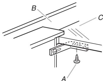
A. Lors de la fixation des brides sous le plan de travail, veiller à utiliser des vis de longueur appropriée, qui ne traverseront pas le plan de travail lors du serrage.
