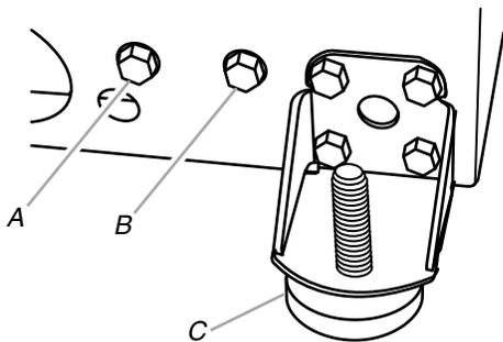
A. Vis de réglage des roulettes arrière
