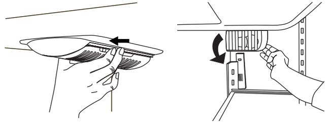
3. Remplacer la ou les ampoule(s) grillée(s) avec une ampoule pour appareil ménager de pas plus de 40 watts.
