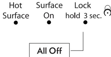
Si une panne de courant survient alors que la table de cuisson est allumée, le témoin lumineux de surface chaude reste allumé jusqu'à 45 minutes après le rétablissement de l'alimentation électrique à la table de cuisson.
