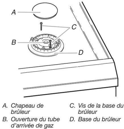
4. Appliquer du ruban adhésif de masquage à l'extrémité d'un tourne-écrou de  $\frac{9}{32}$ " (7,0 mm) pour retenir le gicleur du brûleur pour gaz naturel dans le tourne-écrou durant l'extraction. Placer le tourne-écrou sur le gicleur pour gaz naturel; faire tourner dans le sens antihoraire et soulever pour enlever le gicleur. Conserver le gicleur pour propane..
