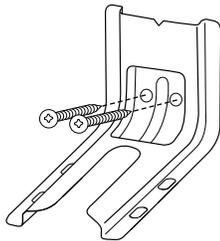
5. À l'aide du tournevis Phillips, monter la bride antibasculement sur le mur ou sur le plancher avec les deux vis n° 12 x 1 5/8" fournies.
