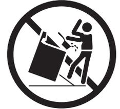
Afin de réduire les risques de renversement, la cuisinière doit être fixée par le support anti-renversement fourni avec la cuisinière. Ce dernier doit être installé correctement. Pour vous assurer que le support est installé correctement, vérifiez que le pied de mise à niveau arrière est inséré et fixé solidement dans le support anti-renversement en enlevant le panneau inférieur ou le tiroir de rangement de la cuisinière.
