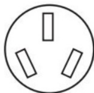
Tomacorriente de 3 hilos (10-50R)
