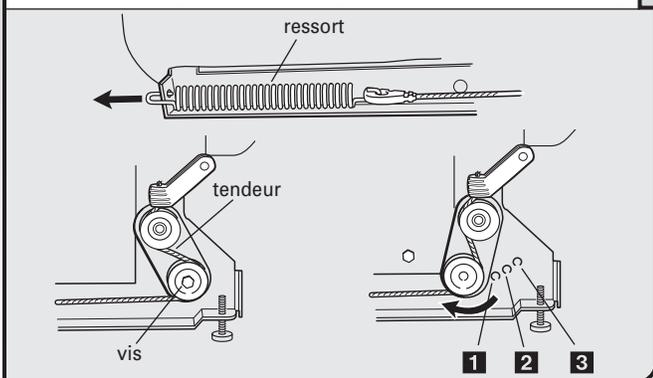
Pour régler la tension du ressort de la porte, détacher le ressort du pied arrière du lave-vaisselle.
