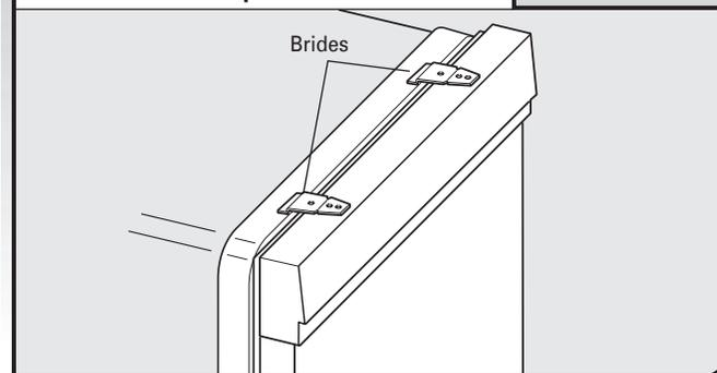
**IMPORTANT :** Le lave-vaisselle doit être fixé au placard. Deux brides de fixation sont situées sur la partie supérieure du lave-vaisselle et peuvent être fixées au plan de travail si celui-ci est fait de bois, de revêtement stratifié ou de tout autre matériau de surface similaire. Si votre plan de travail est en marbre, granit ou autre surface dure, les brides peuvent être déplacées vers les côtés du lave-vaisselle.
