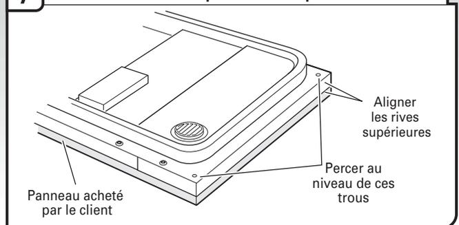
11. Aligner la rive supérieure du panneau sur mesure fourni par le client avec le dessus du tableau de commande.
