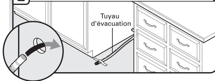
Insérer le tuyau d'évacuation tel qu'indiqué à travers le trou dans le placard et l'acheminer jusqu'au point de raccordement du tuyau d'évacuation (au centre de l'ouverture, à l'avant). Fixer le tuyau d'évacuation au plancher avec du ruban adhésif dans la zone indiquée. Cela l'empêchera de bouger lors de l'insertion du lave-vaisselle dans l'ouverture du placard.
