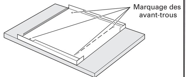
Marquer l'emplacement des quatre trous; ôter le panneau externe. Percer des avant-trous de 3/32" à 1/2" (13 mm) de profondeur dans le panneau personnalisé acheté par le client. Placer le panneau externe à l'arrière du panneau personnalisé acheté par le client; aligner les trous.
