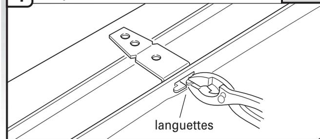
Retirer les brides de la partie supérieure en aplanissant la languette à l'arrière des brides à l'aide d'une pince, et en dégagant les brides des fentes.
