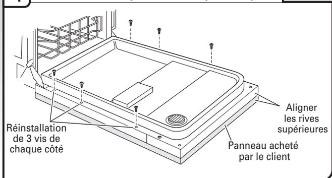
Fixer le panneau à la porte en réinstallant les trois vis de chaque côté.
