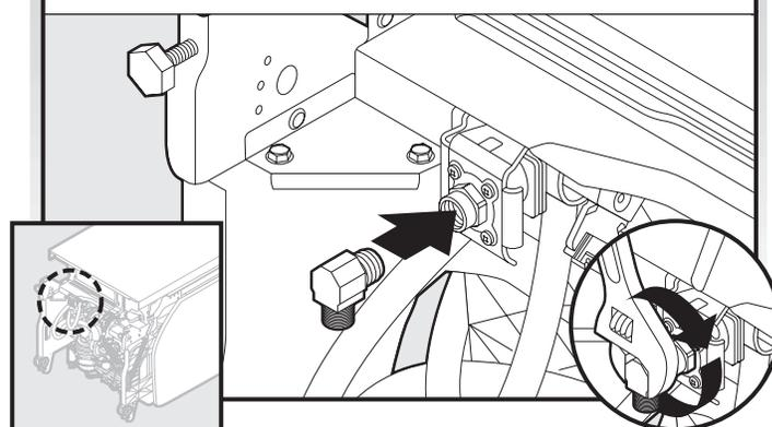
Connecter le raccord coudé de 90° à l'électrovanne d'admission d'eau. Serrer le coude pour bien l'ajuster à l'aide d'une clé et veiller à orienter la sortie du raccord vers l'arrière.
