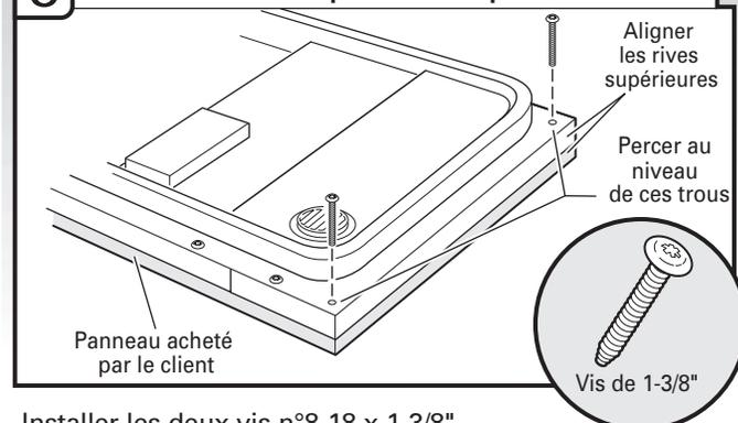
Installer les deux vis n°8-18 x 1-3/8", provenant du sachet de documentation, dans les coins supérieurs du panneau interne. Serrer les six vis latérales réinstallées à l'étape 6.
