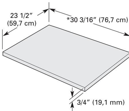
\* Cette dimension est valable pour une bride de calage de 4" (10,2 cm). Si l'installation nécessite une bride de calage plus haute, régler la hauteur du panneau de bois en fonction. Pas recommandé pour les brides de calage supérieures à 6" (15,2 cm).
