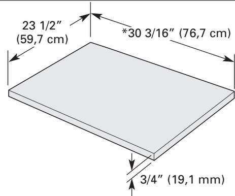
\* Cette dimension est valable pour une bride de calage de 4" (10,2 cm). Si l'installation nécessite une bride de calage plus haute, régler la hauteur du panneau de bois en fonction. Pas recommandé pour les brides de calage supérieures à 6" (15,2 cm).
