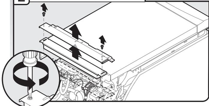
À l'aide d'une clé à douille, un tourne-écrou ou un tournevis Phillips de 1/4", ôter les deux vis fixant le panneau d'accès et le panneau inférieur au lave-vaisselle. Ne pas retirer la fiche technique du panneau d'accès.
