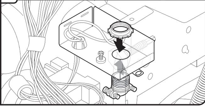
Installer un serre-câble (homologation UL ou CSA). S'assurer que les têtes de vis soit orientées vers la gauche lors du serrage de l'écrou à conduit. Le serre-câble est fourni avec le cordon d'alimentation.
