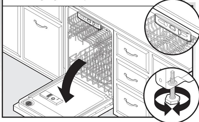
Placer le niveau contre la partie supérieure de l'ouverture avant de la cuve. Vérifier l'aplomb transversal de l'appareil. Si le lave-vaisselle n'est pas d'aplomb, régler la hauteur des pieds avant vers le haut ou vers le bas jusqu'à ce que le lave-vaisselle soit d'aplomb.
