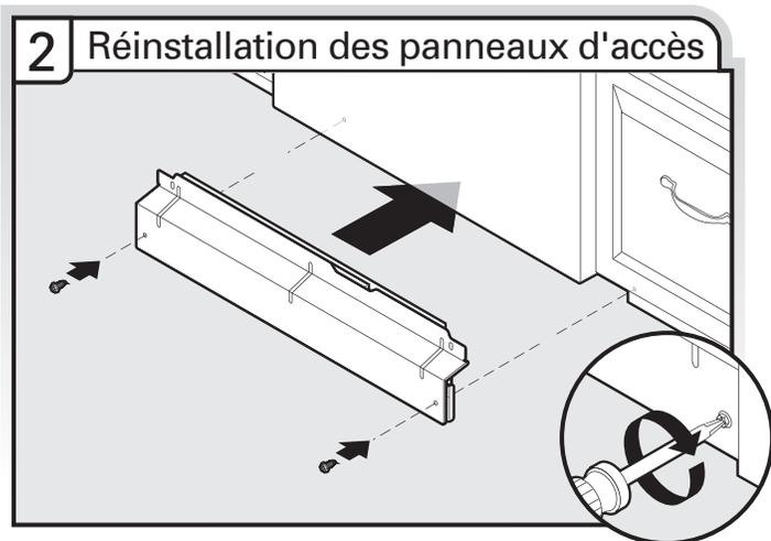
Maintenir les deux panneaux ensemble et les placer contre les pieds du lave-vaisselle. Réinstaller les vis à travers les trous du panneau d'accès et les fentes du panneau inférieur à l'aide d'un tournevis Philips ou tournevis de 1/4".
