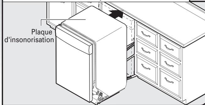
**IMPORTANT** : Si l'on enlève les roulettes, protéger le plancher lors des déplacements du lave-vaisselle. Insérer lentement et complètement le lave-vaisselle dans l'ouverture d'encastrement du placard. Veiller à ne pas coincer la canalisation de cuivre, le tuyau d'évacuation, le cordon d'alimentation ou le câble de raccordement direct entre le lave-vaisselle et le placard. Enlever le carton placé sous le lave-vaisselle.
