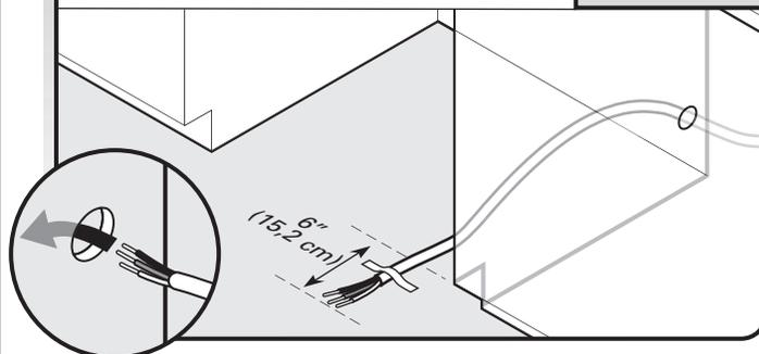
Acheminer le câble de la source d'alimentation électrique à travers le trou dans le placard (le câble doit dépasser par le côté avant droit de l'ouverture d'encastrement du placard).
