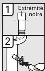
1. Raccorder l'extrémité noire du tuyau d'évacuation à la canalisation d'égout en T et couper si nécessaire. (Ne pas couper la section ondulée).
