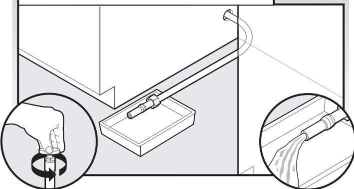
Tourner lentement le robinet d'arrêt jusqu'à la position "ON" (marche). Vider l'eau dans un plat peu profond pour éliminer les particules et débris qui pourraient obstruer l'électrovanne d'admission. Tourner le robinet d'arrêt jusqu'à la position "OFF" (arrêt).
