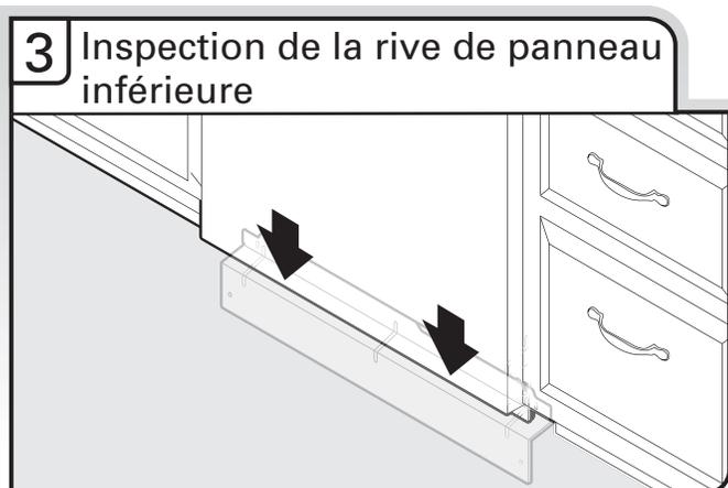
Vérifier que la rive inférieure du panneau inférieur est au contact du plancher. Le réajuster au besoin.
