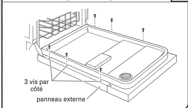
Mettre le panneau externe de côté avec précaution. Placer le panneau personnalisé acheté par le client orienté vers le bas sur une surface couverte et lisse. Positionner le panneau externe à l'arrière du panneau personnalisé acheté par le client tel qu'illustré; s'assurer que la rive supérieure du panneau externe est alignée avec celle du panneau personnalisé acheté par le client, et que les deux panneaux sont centrés côte à côte.
