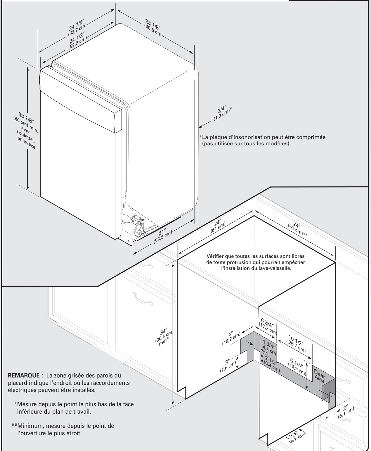
**REMARQUE :** La zone grisée des parois du placard indique l'endroit où les raccordements électriques peuvent être installés.
