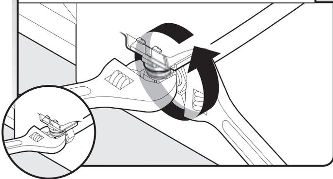
Maintenir en place le raccord coudé de 90° à l'aide d'une clé à molette et serrer l'écrou à l'aide d'une seconde clé à molette.
