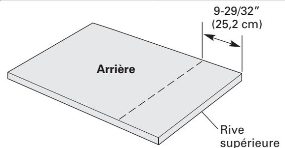
Mesurer 9 29/32" (25,2 cm) à partir de la rive supérieure et tracer un axe à l'arrière du panneau personnalisé acheté par le client. Positionner le panneau externe à l'arrière du panneau personnalisé acheté par le client tel qu'illustré, de façon à ce que les trous supérieurs dans le panneau externe se trouvent sur l'axe et que les deux panneaux soit centrés côte à côte.
