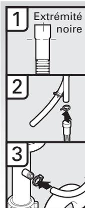
1. Raccorder l'extrémité noire du tuyau d'évacuation au dispositif de brise-siphon et couper si nécessaire. (Ne pas couper la section ondulée).
