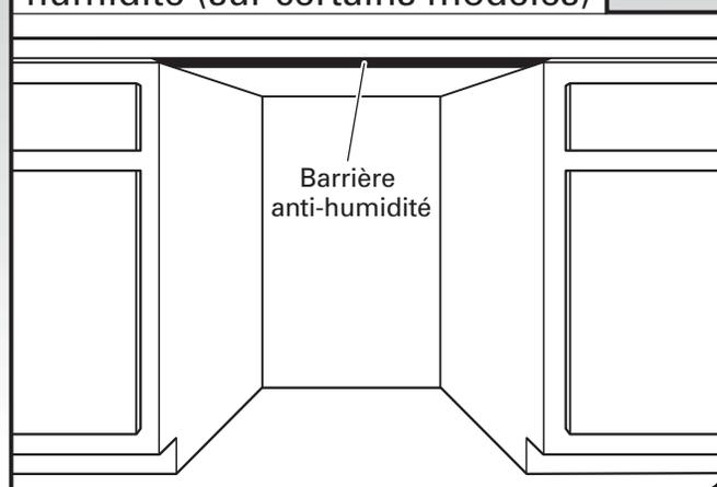
1. Veiller à ce que la zone se trouvant sous le placard soit propre et sèche avant d'installer la barrière anti-humidité.
