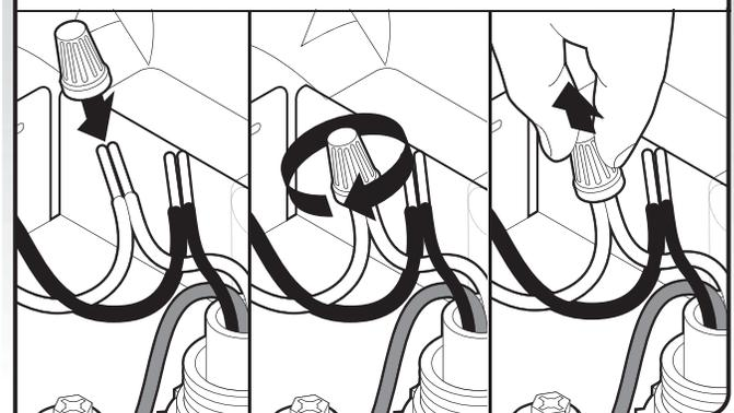
**REMARQUE :** Installer le connecteur de fils en le faisant pivoter. Tirer doucement sur les conducteurs pour vérifier qu'ils sont bien fixés.
