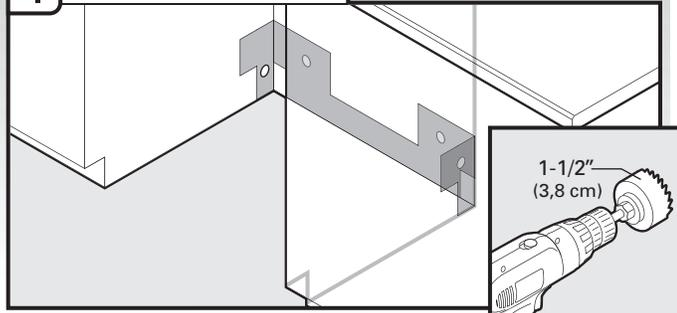
Si nécessaire, percer un trou de 1 1/2" (3,8 cm) de diamètre dans la paroi du placard ou l'arrière de l'ouverture la plus proche de l'évier.
