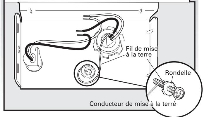
Former un crochet en U avec le conducteur nu de liaison à la terre. Enrouler le crochet du conducteur de liaison à la terre sur la vis de liaison à la terre et sous la rondelle (dans le sens horaire). Serrer fermement le conducteur de liaison à la terre.
