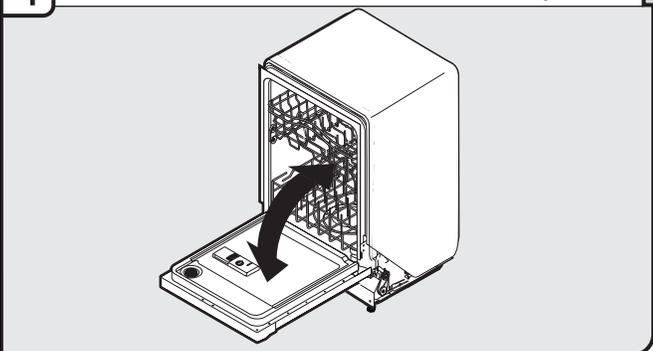
Alors qu'une autre personne retient l'appareil pour l'empêcher de basculer, ouvrir et refermer la porte plusieurs fois. Si la porte se ferme ou s'ouvre sous l'effet de son propre poids, il sera nécessaire d'ajuster la tension du ressort de la porte.
