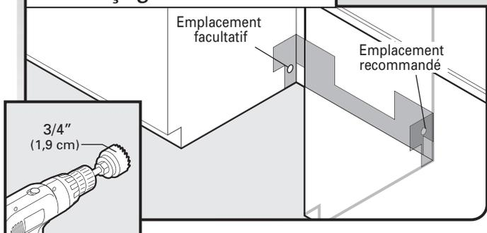
Percer un trou de 3/4" (1,9 cm) dans le côté droit de la paroi latérale ou arrière du placard.
