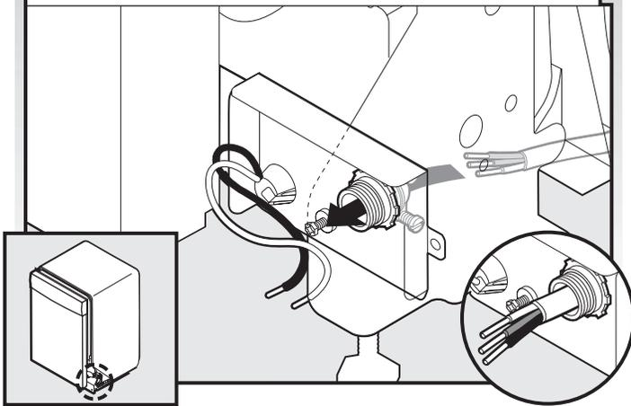
Acheminer le cordon d'alimentation de façon à ce qu'il ne touche ni le moteur du lave-vaisselle, ni la partie inférieure de la cuve du lave-vaisselle. Tirer le câble pour le faire passer à travers le serre-câble (homologation UL/CSA) dans le boîtier de connexion. Le serre-câble n'est pas fourni avec le lave-vaisselle. Le propriétaire doit acheter un serre-câble de 7/8" de type à visser.
