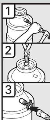
1. À l'aide d'un marteau et d'un tournevis, enfoncer le bouchon d'obturation dans le broyeur à déchets.
