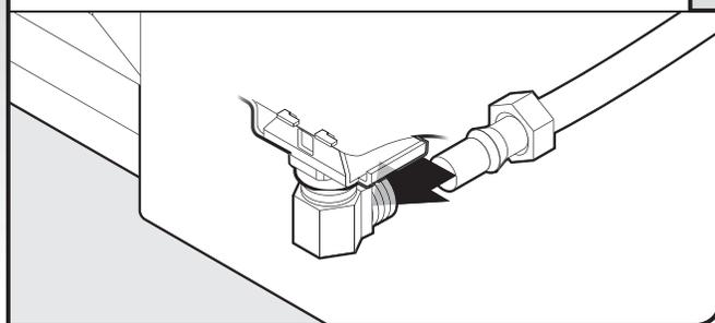
Canalisation en cuivre uniquement : Insérer la canalisation dans le raccord coudé de 90° aussi loin que possible (la canalisation en cuivre se plie et s'écrase facilement). Faire glisser l'écrou et la virole vers l'avant et engager l'écrou sur le filetage du raccord coudé.
