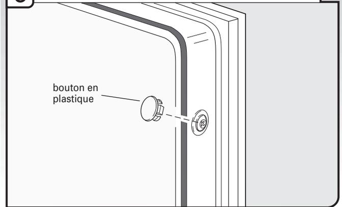
Dans le cas de la fixation sur les placards latéraux, vérifier que les côtés de la porte ne frottent pas contre les têtes de vis. S'il y a frottement, centrer à nouveau le lave-vaisselle. Une fois le lave-vaisselle correctement centré, réinstaller les opercules de plastique.
