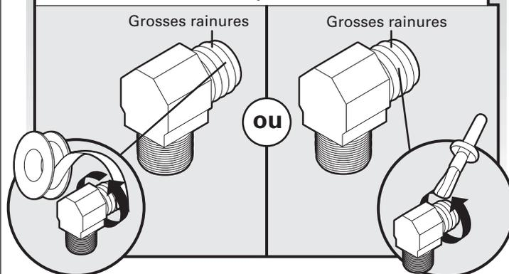
Garnir le filetage du raccord coudé de 90° de ruban de Teflon® ou de composé d'étanchéité pour tuyauteries (non fournis). Enrouler du ruban adhésif de deux à quatre tours autour des fils de grosse taille pour empêcher toute fuite.
