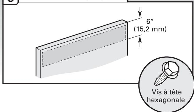
Installer le panneau externe sur l'arrière du panneau sur mesure fourni par le client à l'aide des quatre vis à tête hexagonales n°10-16 x 3/8" fournies avec le sachet de documentation. Installer la poignée. La poignée doit être centrée sur l'avant du panneau sur mesure fourni par le client dans la zone illustrée.
