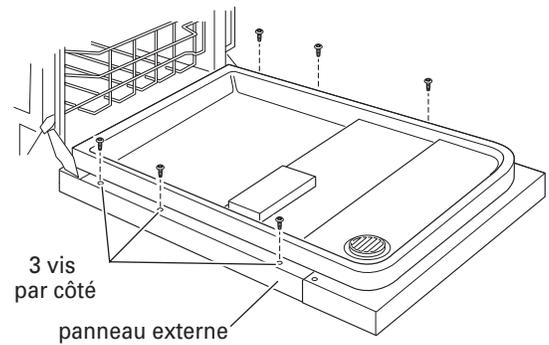
Mettre le panneau externe de côté avec précaution. Placer le panneau personnalisé acheté par le client orienté vers le bas sur une surface couverte et lisse.
