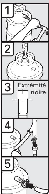
1. À l'aide d'un marteau et d'un tournevis, enfoncer le bouchon d'obturation dans le broyeur à déchets.
