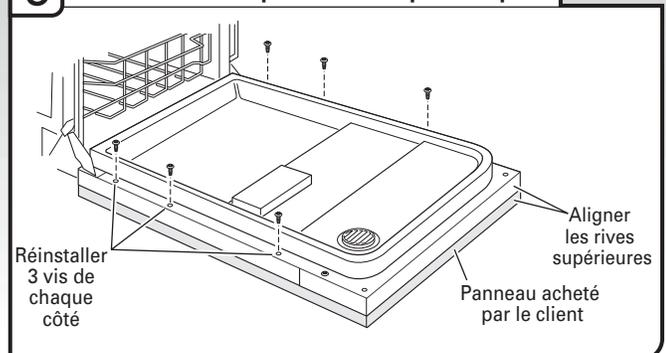
Installer le panneau sur la porte en réinstallant les trois vis de chaque côté; ne pas les serrer complètement. Ceci tiendra le panneau en place sur le cadre de la porte.
