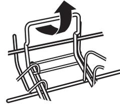
2. Une fois que la poignée est soulevée, incliner vers la gauche ou vers la droite pour libérer les pieds d'insertion à l'autre extrémité de leur emplacement sous la grille métallique de la base.
