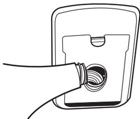
3. Prendre soin de ne pas renverser d'agent de rinçage dans le tiroir. Tout renversement doit être essuyé pour éviter un excès de mousse.
