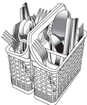
Utiliser la section centrale avec le couvercle vers le bas pour charger les couverts en position fixe et éviter les imbrications. Assortir les articles dans les extrémités du panier, certains pointant vers le haut et d'autres vers le bas afin que les articles ne s'imbriquent pas. Le jet d'eau ne peut atteindre les articles imbriqués.
