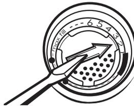
**REMARQUE :** Pour une majorité de types d'eau, le réglage effectué à l'usine à 2 donnera de bons résultats. En cas d'eau dure ou d'observation d'anneaux ou dépôts, essayer un réglage plus élevé. Tourner l'ajusteur à flèche à l'intérieur du distributeur soit à la main, soit en insérant un tournevis à lame plate au centre de la flèche et en tournant.
