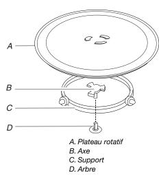
Le plateau rotatif tourne dans les deux sens pour permettre une cuisson plus uniforme. Pour les meilleurs résultats de cuisson, ne pas faire fonctionner le four à micro-ondes sans que le plateau rotatif ne soit en place. Voir "Assistance ou service" pour passer une nouvelle commande de pièces.
