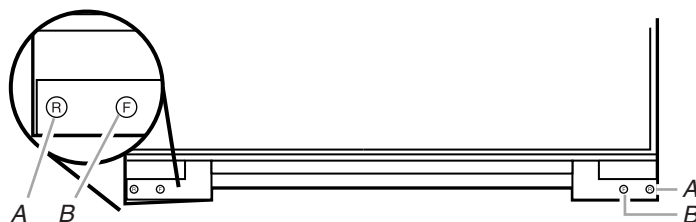
A. Boulon de réglage de l'aplomb (arrière) B. Boulon de réglage de l'aplomb (avant)
