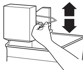
2. Installer le filtre à eau intérieur. La bride de montage du filtre à eau intérieur est située du côté gauche du compartiment de réfrigération.
