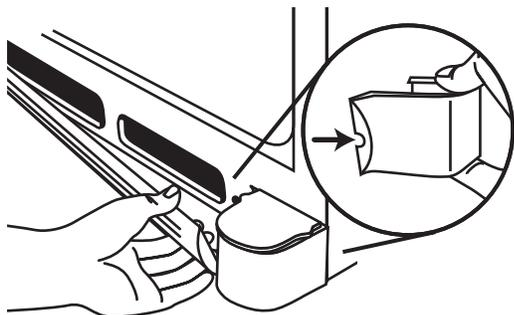
4. À l'aide d'un tournevis ou d'un tournevis à tête hexagonale de  $\frac{3}{8}$ " , tourner les vis de réglage avant ou arrière de chaque côté pour relever ou abaisser l'avant ou l'arrière du réfrigérateur.
