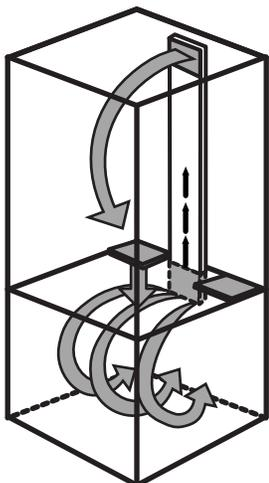
Ne pas obstruer l'une ou l'autre de ces ouvertures d'aération avec des emballages d'aliments. Si les ouvertures d'aération sont obstruées, le débit d'air sera bloqué et des problèmes de température et d'humidité surviendront.
