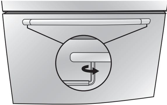
4. En tournant la clé de gauche à droite, serrer la vis de blocage d'un quart de tour à la fois. Répéter l'opération jusqu'à ce que la vis soit serrée.
