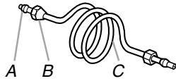
A. Manchon à compression C. Tuyau en cuivre B. Écrou de compression
