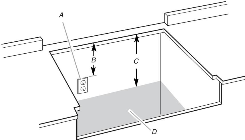
A. La prise de courant à 3 alvéoles reliée à la terre doit se trouver du côté gauche de l'ouverture, à 8" (20,3 cm) max. de la paroi latérale
