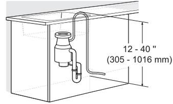
**Conexión al triturador sin trampa de aire**
