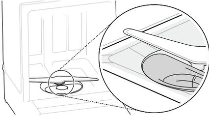
Tras extraer la bandeja inferior, coloque un nivel en la pared interior de la cuba para verificar que el lavavajillas esté nivelado de lado a lado.
