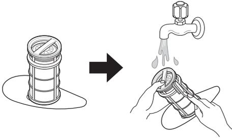
**4** Para volver a colocar los filtros ensamblados, coloque el brazo rociador de modo que la V más amplia apunte hacia adelante. Encaje los filtros nuevamente en el soporte de filtros y asegúrelos haciendo girar el filtro interior en el sentido de las agujas del reloj hasta que haga clic en su lugar.
