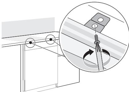
**Sujeción del lavavajillas al bastidor del gabinete**
