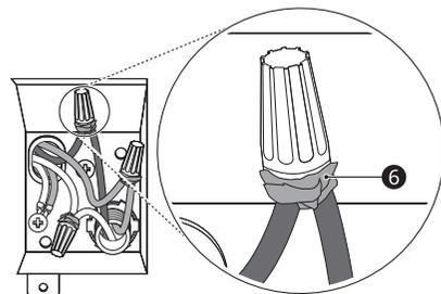
**10** Pliegue los cables conectados, introdúzcalos nuevamente dentro de la caja de empalmes y atornille la cubierta de la caja.
