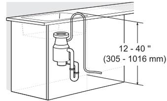
**Conexión al triturador sin trampa de aire**
