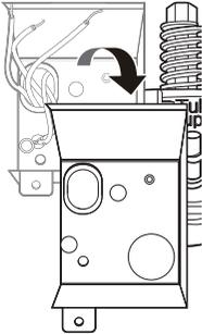
**5** Inserte un aliviador de tensión **2** de 3/8" a través del orificio de la caja de empalmes. Apriete la tuerca redonda **3** para asegurarlo en su sitio.
