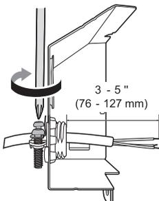
**7** Tire de los cables existentes a través de las aberturas de la caja de empalmes. Ajuste los 2 tornillos **4** para volver a ensamblar la caja de empalmes en el artefacto.
