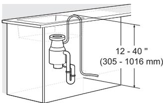
**Conexión al triturador sin trampa de aire de aire**
