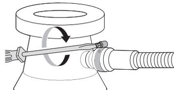
**Conexión a la pieza en T para desechos sin trampa de aire**
