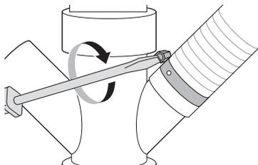
**Conexión al triturador o a la pieza en T para desechos con trampa de aire**
