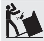
*Si se quita la cocina para efectuar una limpieza, reparaciones o cualquier otra razón, verifique que el dispositivo anti-volcaduras se coloque de manera adecuada cuando vuelva a instalarse la cocina. Si no toma esta precaución, la cocina puede volcarse y provocar daños.*
