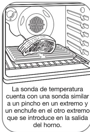
La sonda de temperatura cuenta con una sonda similar a un pincho en un extremo y un enchufe en el otro extremo que se introduce en la salida del horno.
