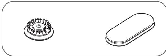
Les têtes des brûleurs et l'assemblage de tête/couvercle du brûleur ovale sont amovibles. Ôtez-les simplement de la cuisinière pour les nettoyer. Les fentes des têtes des brûleurs doivent toujours être maintenues propres pour disposer d'une flamme régulière et libre. Des orifices ou des électrodes obstrués ou encrassés empêchent le brûleur de fonctionner correctement.
