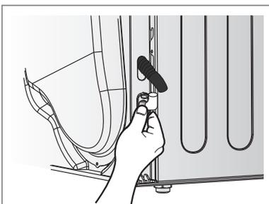
3. Raccordez le tuyau d'évacuation externe fourni avec le sèche-linge. Branchez ce tuyau sur un réseau d'évacuation permanent et serrez-le bien pour qu'il ne risque pas de se défaire.
