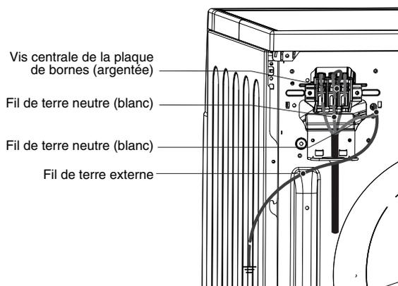
1. Raccordez le fil neutre (blanc) du cordon d'alimentation à la vis centrale de la plaque de bornes.
