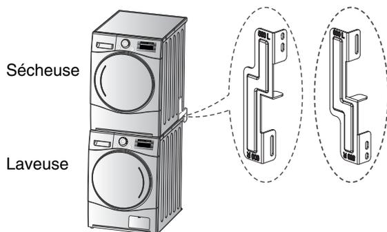
Cette sècheuse peut uniquement être superposée sur une laveuse LG. NE TENTEZ PAS de superposer cette sècheuse sur une autre laveuse, car cela pourrait provoquer des dommages, des blessures ou des dégâts matériels.
