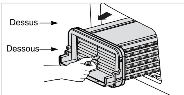
4. Nettoyez soigneusement le condenseur en le passant sous l'eau du robinet, à l'avant et sur les côtés.
