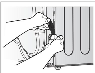
2. Débranchez le tuyau qui monte jusqu'au réservoir.
