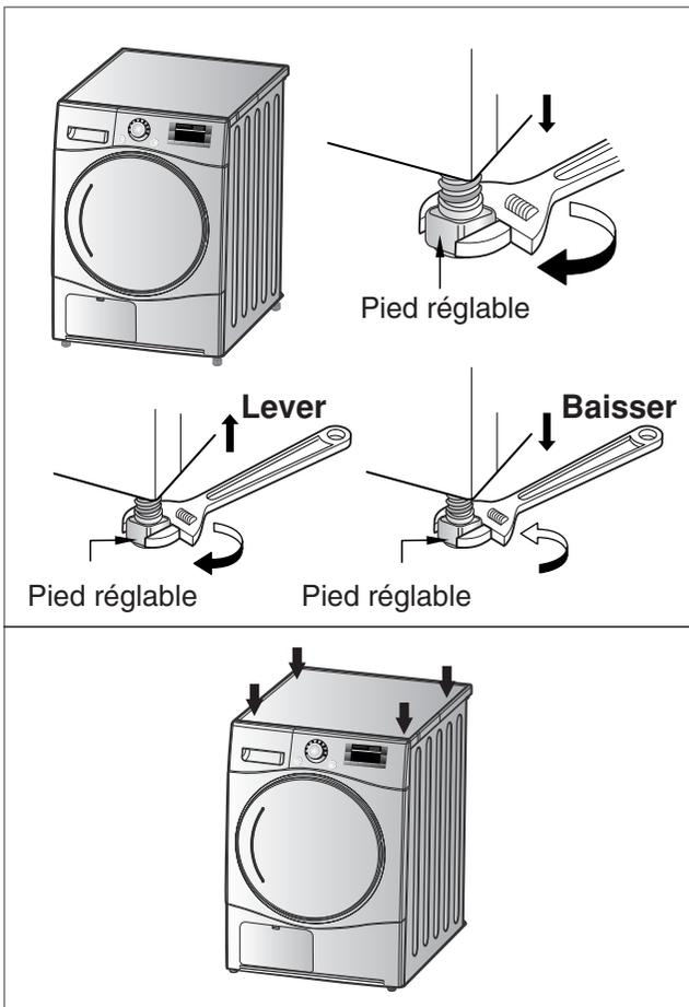
2. Si le sèche-linge n'est pas correctement à niveau, réglez les pieds de mise à niveau à l'avant vers le haut ou vers le bas si nécessaire.
