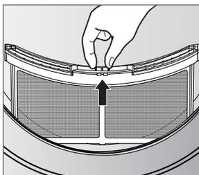
3. Ouvrez le filtre et retirez les peluches avec vos doigts. Si les peluches sont difficiles à retirer ou si le filtre semble obstrué, appliquez les instructions de nettoyage suivantes.
