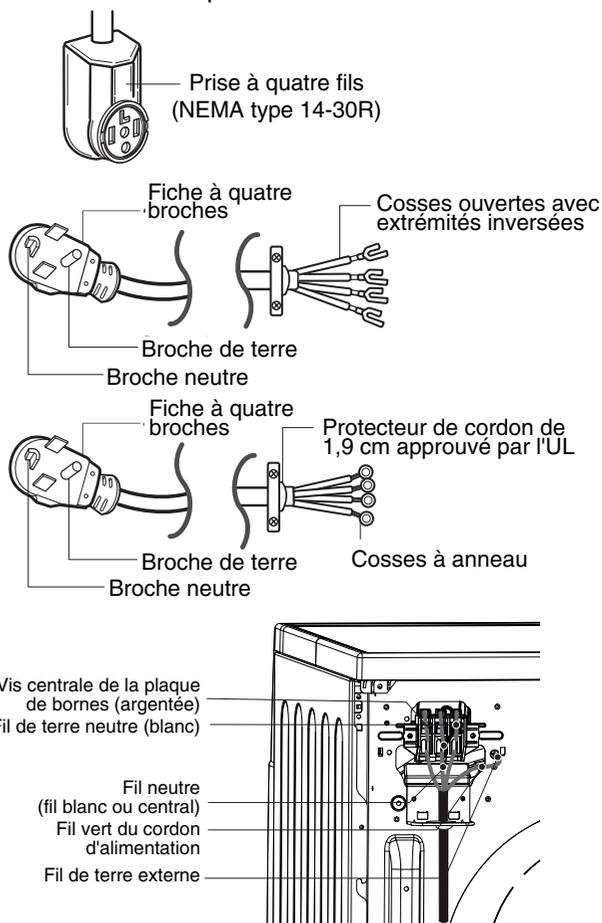
1. Raccordez le fil neutre (blanc) du cordon d'alimentation à la vis centrale de la plaque de bornes.
