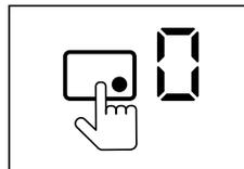
Presione el botón de la zona de cocción deseada para ajustar el nivel de potencia. La indicación '0' del quemador parpadeará.
