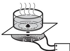
En lugar de calentar el vidrio cerámico, este método calienta la base de la sartén inmediatamente, lo que ahorra tiempo y energía. Dado que el calor requerido para cocinar se genera directamente en la base de la sartén, la zona de cocción en sí se calienta muy poco. La placa de cocción se calienta cuando se transfiere calor de los utensilios de cocina.
