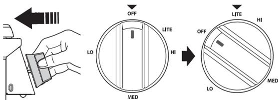
El sistema de encendido por chispa eléctrica hace un clic. Una vez encendido el quemador, gire el mando en sentido anti horario hasta la posición **HI** para dejar de oír el ruido del clic.
