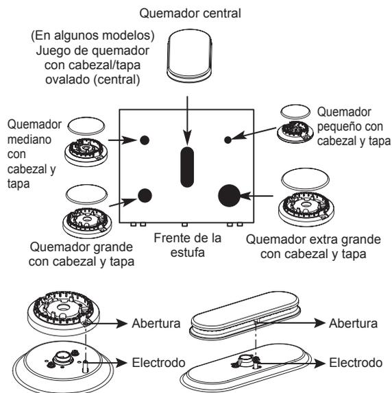
Asegúrese de que el agujero del cabezal del quemador esté ubicado sobre el electrodo.
