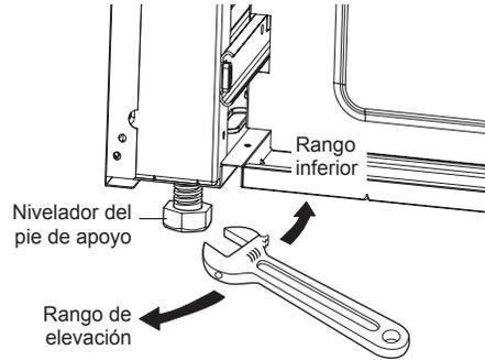
Utilice un nivelador para verificar sus ajustes. Ubique el nivelador en diagonal sobre el estante del horno y verifique en todas direcciones para nivelar.
