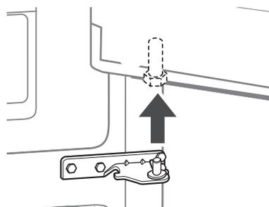
**Ensamblando la Puerta Derecha del Refrigerador**
