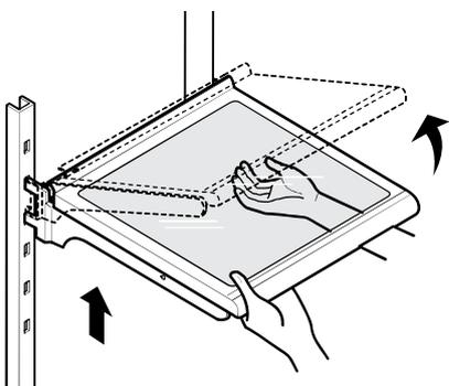
**3** Para ensamblarlo, incline hacia arriba la parte frontal del estante y guíe los ganchos hacia dentro de las ranuras a la altura deseada.
