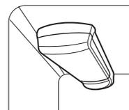
3. Luego de reemplazar el filtro de agua, dispense 9 litros de agua (deje correr el agua durante aprox. 5 minutos) para purgar el aire atrapado y los contaminantes del sistema. No dispense los 9 litros de agua de manera continua. Pulse y suelte el botón del dispensador en ciclos de 30 segundos ON (encendido) y 60 segundos OFF (apagado).
