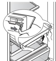
1. Sujete el asa delantera del cajón y gire hasta el tope.
