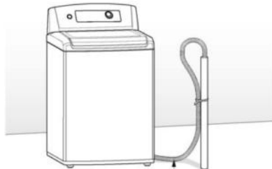
Manguera de drenaje
