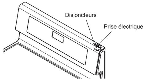
Les prises de 120 V pour appareils électroménagers situées sur la console de commande peuvent être utilisées pour des appareils électroménagers portables placés sur le comptoir à côté de la cuisinière. Ces prises fonctionnent de manière indépendante et ne sont pas affectées par le réglage des commandes de la cuisinière.
