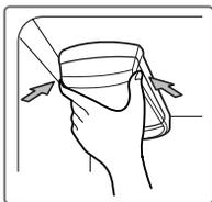
**NOTA:** Al reemplazar el filtro de agua, drene una pequeña cantidad de agua (aprox. 25 cc.). Coloque un vaso debajo de la parte delantera de la tapa del filtro de agua para recoger el agua que salga. Sostenga el filtro de agua extraído en posición vertical, para evitar que el agua remanente salga del filtro de agua.
