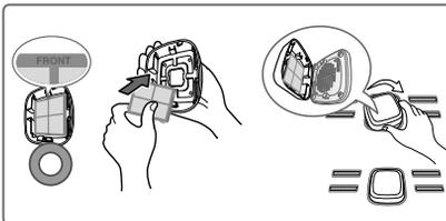
Una vez que haya cambiado el filtro de agua, mantenga pulsado el botón Air Filter durante tres segundos para reiniciar el sensor del filtro.
