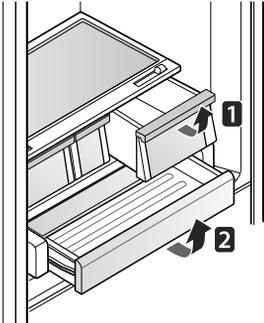
Para instalarlo, incline la parte delantera ligeramente hacia arriba, inserte el cajón en el marco y empuje hasta que encaje en su sitio.
