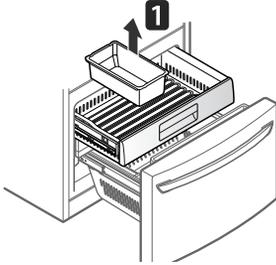
En el riel izquierdo, empuje con un desarmador de punta plana la lengüeta para liberar la gaveta del riel, como se ilustra a continuación. Una vez que esté liberado el lado izquierdo, empuje la lengüeta del lado derecho con el dedo para liberar la gaveta. Levante la parte delantera de la gaveta y luego júlela hacia afuera.
