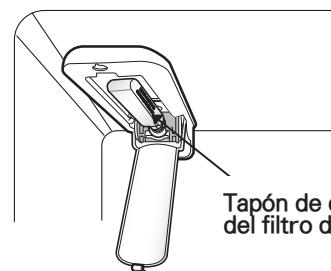
Tapón de derivación del filtro de agua
