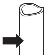
3. TALADRE EL ORIFICIO PARA LA VÁLVULA. Taladre un orificio de  $\frac{1}{4}$  pulg. en la tubería de agua mediante una punta afilada. Quite todas las rebabas resultantes de taladrar el orificio en la tubería. Tenga cuidado de que no caiga agua en el taladro. Si no se taladra un orificio de  $\frac{1}{4}$  de pulg., podría verse reducida la producción de hielo y el tamaño de los cubitos.
