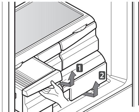
Para instalarlo, incline la parte delantera ligeramente hacia arriba, inserte el cajón en el marco y empuje hasta que encaje en su sitio.
