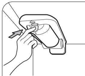
**NOTA:** Al reemplazar el filtro de agua, drena una pequeña cantidad de agua (aprox. 25 cc.). Coloque un vaso debajo de la parte delantera de la tapa del filtro de agua para recoger el agua que salga. Sostenga el filtro de agua extraído en posición vertical, para evitar que el agua remanente salga del filtro de agua.
