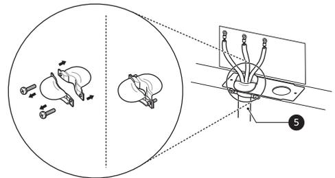
Para instalaciones de conductos, inserte el pasacables del conducto en el orificio correspondiente de 1 1/8 pulgadas (2.8 cm). Luego, instale el conducto a través del cuerpo del pasacables y ajústelo con su anillo.
