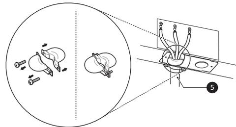
Para instalaciones de conductos, inserte el pasacables del conducto en el orificio correspondiente de 1 1/8 pulgadas (2.8 cm).
