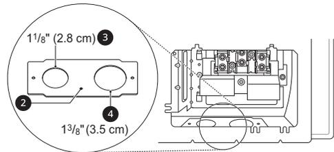
Para instalaciones con cable de alimentación **5**, enganche el pasacables sobre el orificio para cable de alimentación de 1 3/8 pulg. (3.5 cm), ubicado por debajo de la parte trasera del horno. Inserte el cable de alimentación a través del pasacables y ajústelo.
