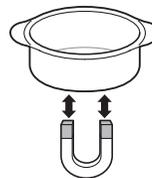
Para obtener los mejores resultados de cocción en la superficie, utilice solo utensilios de cocina de acero de alta calidad y de gran calibre en los elementos de cocción por inducción. Siga las recomendaciones del fabricante cuando utilice utensilios de cocina de inducción.
