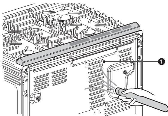
**Quemadores de superficie de gas****Retiro y colocación de los quemadores de superficie de gas**
