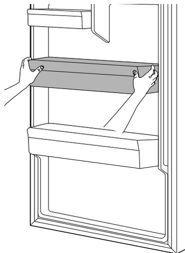
**2** Para ensamblar el recipiente, deslícelo hacia adentro sobre el soporte deseado y empújelo hasta que calce en su lugar.
