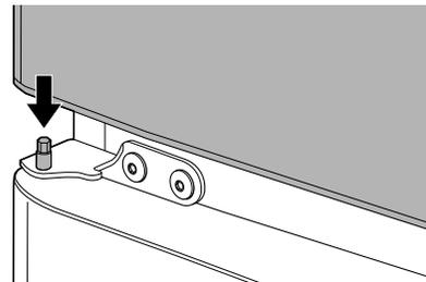
**3** Coloque la bisagra superior sobre la puerta del congelador y alinee la bisagra superior con los orificios en la parte superior del refrigerador. Use los tres pernos para sujetar la bisagra.
