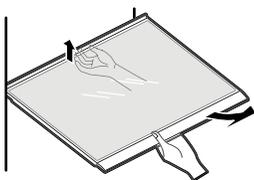
**2** Para ensamblarlo, deslice el estante en las guías hasta que se detenga.
