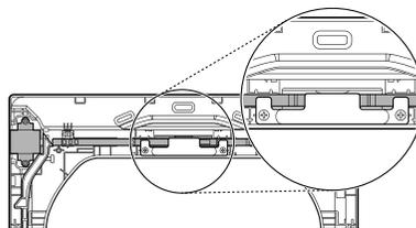
**8** Revierta el ensamble de la bisagra superior **7** y el relleno de la bisagra **11**.
