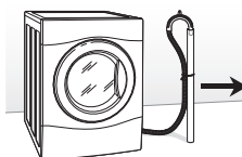
Raccordement de la conduite d'évacuation
