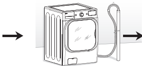
Raccordement de la conduite d'évacuation
