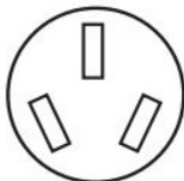
Tomacorriente de 3 hilos (10-50R)
