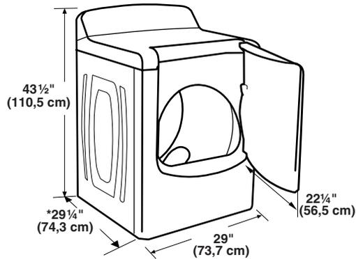
\*La plupart des installations requièrent un espace minimum de 5" (12,7 cm) derrière la sécheuse pour le conduit d'évacuation avec coude. Voir "Exigences concernant l'évacuation".
