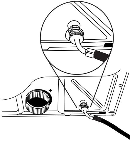
**REMARQUE :** Ne pas serrer excessivement. Le raccord risque d'être endommagé.
