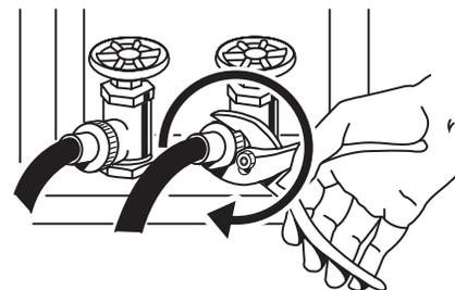
**REMARQUE :** Ne pas serrer excessivement. Le raccord risque d'être endommagé.
