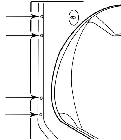
6. Installer 4 chevilles de plastique dans les trous des vis sur la gauche de la sécheuse après avoir retiré les charnières (Étape 4).
