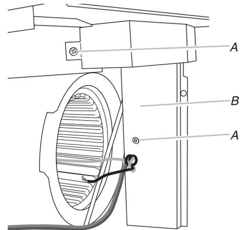
A. Vis du couvercle du boîtier de connexion
