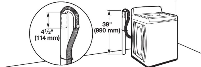
Diamètre minimal pour un tuyau de rejet à l'égout : 2" (51 mm). Capacité minimale d'acheminement : 17 gal. (64 L) par minute. Le sommet du tuyau de rejet à l'égout doit avoir une hauteur d'au moins 39" (990 mm); ne pas l'installer à plus de 96" (2,4 m) du fond de la laveuse. Si on doit l'installer à plus de 96" (2,4 m) de hauteur, un système de pompe de puisard est nécessaire.
