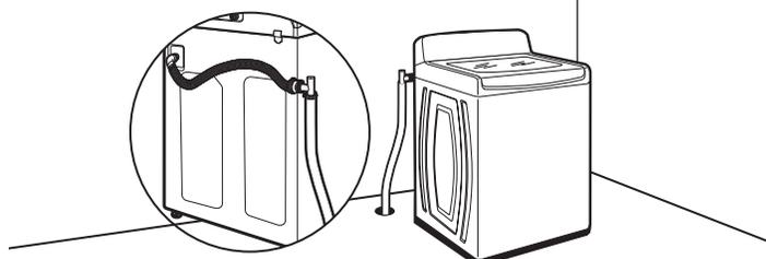
Le système de vidange au plancher nécessite un ensemble de brise-siphon (pièce numéro 285834), deux ensembles de connection (pièce numéro 285835), et un tuyau de vidange supplémentaire (pièce numéro 285863) qui peuvent être achetés séparément. Pour commander, consulter les numéros d'appel sans frais figurant dans les "Instructions d'utilisation" de la laveuse. Dimension minimale pour le brise-siphon : 28" (710 mm) à partir du fond de la laveuse. (Des tuyaux supplémentaires peuvent être requis).
