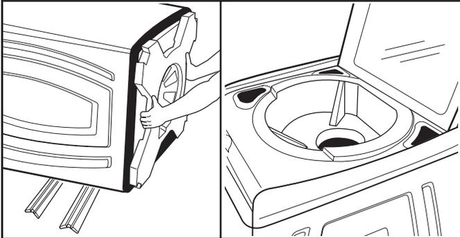
Placer des supports de carton de la boîte d'emballage en carton sur le sol derrière la laveuse. Fixer le couvercle avec du ruban adhésif. À l'aide de deux personnes ou plus, incliner la laveuse sur sa partie arrière et la placer sur les supports de carton. Ôter la base d'expédition en mousse. Remettre ensuite la laveuse debout et retirer le ruban adhésif du couvercle de façon à pouvoir ouvrir le couvercle et retirer l'emballage en anneau de la cuve de la laveuse.
