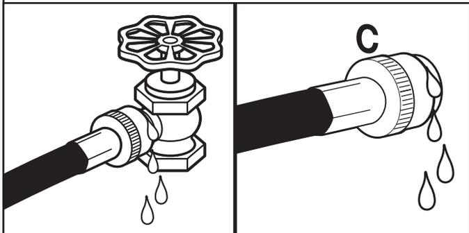
Ouvrir les deux robinets pour vérifier l'absence de fuite au niveau du robinet et du raccordement des rondelles. Une petite quantité d'eau peut entrer dans la laveuse. Vous effectuerez une vidange lors d'une étape ultérieure.
