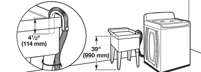
Capacité minimale : 20 gal. (76 L). Le sommet de l'évier de buanderie doit se trouver à au moins 39" (990 mm) du plancher; ne pas l'installer à plus de 96" (2,4 m) du fond de la laveuse.
