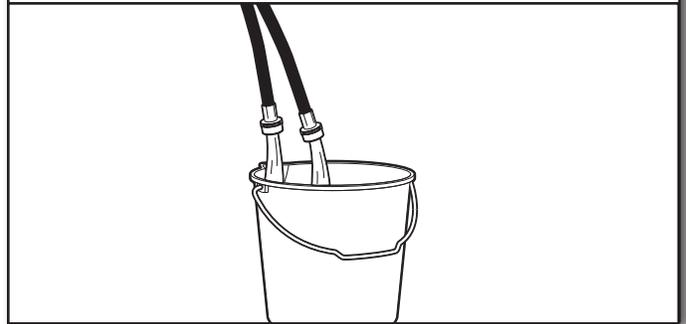
Faire couler de l'eau dans les tuyaux de l'évier de buanderie, le tuyau rigide de rejet à l'égout ou le seau pendant quelques secondes pour éviter toute obstruction. On doit laisser couler l'eau jusqu'à ce qu'elle soit limpide. Vérifier la température de l'eau pour s'assurer que le tuyau d'eau chaude est connecté au robinet d'eau chaude et que le tuyau d'eau froide est connecté au robinet d'eau froide.
