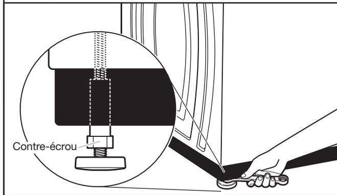
Si la laveuse n'est pas d'aplomb, utiliser une clé plate ou une clé à molette de 9/16" ou 14 mm pour tourner les contre-écrous dans le sens horaire jusqu'à ce qu'ils se trouvent à environ 1/2" (13 mm) de la caisse de la laveuse. Tourner ensuite le pied de nivellement dans le sens horaire pour abaisser la laveuse ou antihoraire pour la soulever. Contrôler à nouveau l'aplomb de la laveuse et répéter au besoin.
