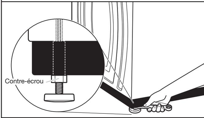
Une fois l'aplomb de la laveuse établi, utiliser une clé plate ou une clé à molette de 9/16" ou 14 mm pour tourner les contre-écrous sur les pieds de nivellement dans le sens anti-horaire et les serrer fermement contre la caisse de la laveuse.
