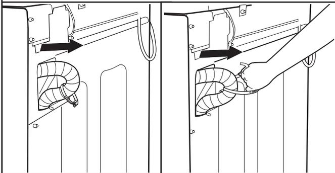
Libérer doucement le tuyau de vidange de la caisse de la laveuse jusqu'à ce que l'extrémité émerge.
