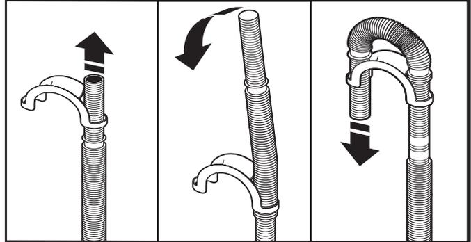
Pour un système d'évacuation par l'évier de buanderie ou le tuyau rigide de rejet à l'égout, fixer le support de fixation pour tuyau d'évacuation. Pour un système d'évacuation au plancher, ne pas installer le support de fixation pour tuyau d'évacuation. Des pièces supplémentaires avec des directives distinctes seront peut-être nécessaires. Voir "Outils et pièces" pour déterminer les outils nécessaires.
