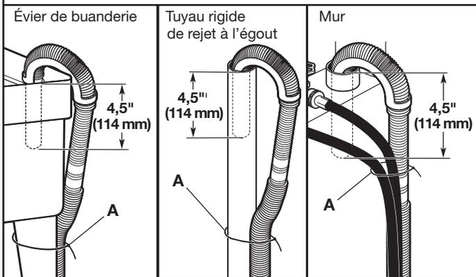
Fixer le tuyau d'évacuation au pied de l'évier de buanderie, au tuyau rigide de rejet à l'égout ou aux tuyaux d'arrivée d'eau pour le tuyau de rejet à l'égout mural avec l'attache-câble (A). Ceci aidera à réduire le risque d'éclaboussement d'eau sur le plancher.
