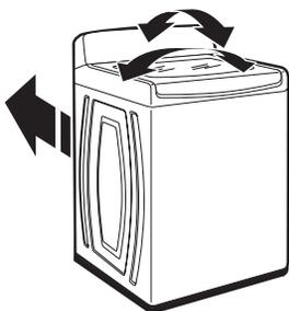
Déplacer la laveuse à son emplacement final. Pousser la laveuse d'avant en arrière pour vérifier que les quatre pieds sont stables et en contact ferme avec le plancher. Si la laveuse bascule, de petits réglages seront peut-être nécessaires pour mettre la laveuse d'aplomb sur le plancher.
