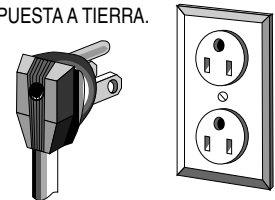
TOMACORRIENTE DEL TIPO CON PUESTA A TIERRA
