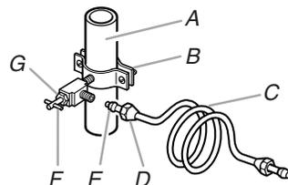
A. Canalisation d'eau froide      E. Bague de compression
