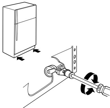
3. Ouvrir les deux portes de nouveau pour s'assurer qu'elles se ferment aussi facilement que désiré et qu'elles restent fermées. Si ce n'est pas le cas, incliner le réfrigérateur un peu plus vers l'arrière en tournant les deux vis de nivellement vers la droite. Plusieurs tours supplémentaires peuvent être nécessaires.
