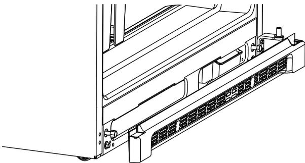
8. À l'aide d'une clé à douille à tête hexagonale, retirer les deux vis de charnière à tête hexagonale de 5/16" fixant la charnière inférieure à la caisse et les dégager de la charnière située sur le bas de la porte du réfrigérateur.
