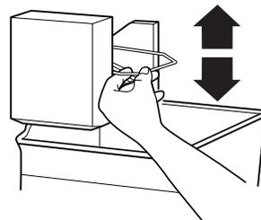
**REMARQUE :** Éteindre la machine à glaçons avant de retirer le bac d'entreposage à glaçons pour servir des glaçons ou pour nettoyer le bac. Ceci empêchera les glaçons de tomber de la machine à glaçons dans le compartiment de congélation. Après avoir réinstallé le bac d'entreposage, mettre en marche la machine à glaçons.
