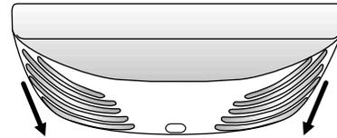
3. Retirer l'ampoule et la remplacer par une ampoule de même taille et forme.
