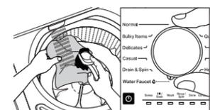
■ Tourner le bouton de programme sur Water Faucet (Robinet d'eau) et maintenir enfoncé le bouton de Start (mise en marche) pour mettre en marche, appuyer sur le bouton de Pause (pause) ou Power (mise sous tension) pour éteindre.
