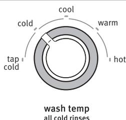
Une fois le programme choisi, sélectionner la température de lavage désirée en tournant le bouton de température de lavage au réglage souhaité.
