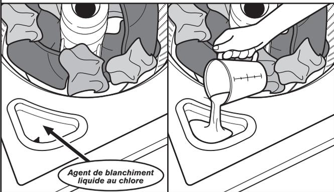
Ne pas remplir excessivement le distributeur. Ne pas utiliser plus d'une tasse (250 mL) d'agent de blanchiment liquide au chlore ni le diluer. Ne pas utiliser d'agent de blanchiment sans danger pour les couleurs ni de produit Oxi avec un programme utilisant de l'agent de blanchiment au chlore liquide.
