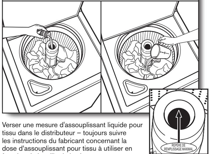
Verser une mesure d'assouplissant liquide pour tissu dans le distributeur – toujours suivre les instructions du fabricant concernant la dose d'assouplissant pour tissu à utiliser en fonction de la taille de la charge.
